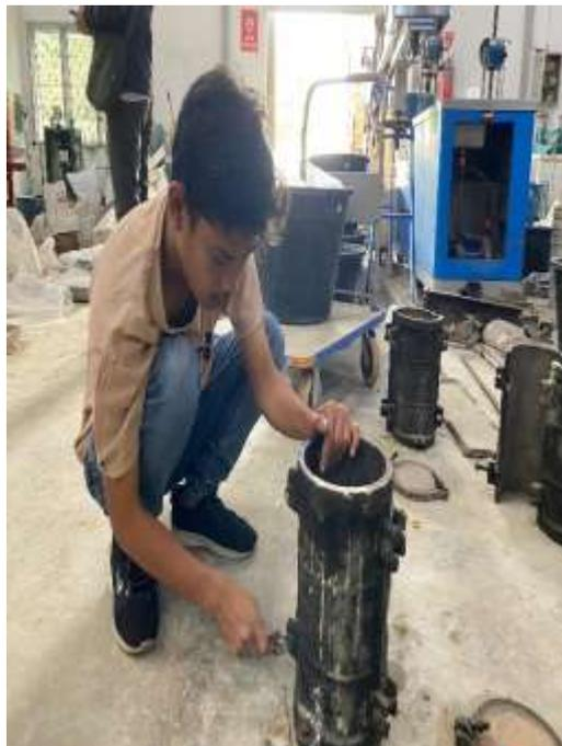
Gambar Lampiran- 2: Perakitan cetakan beton
