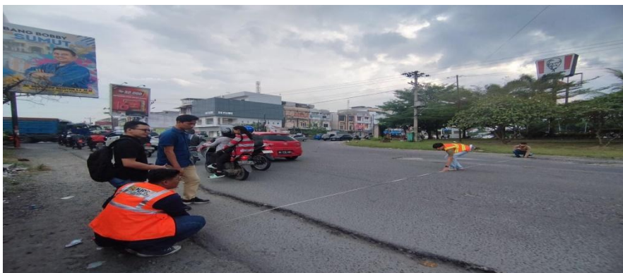
Gambar L.3: Menghitung Lebar Pendekatan Jalan.
