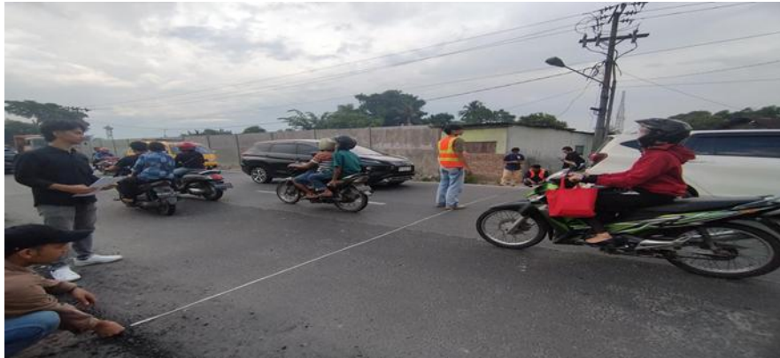
Gambar L.1: Menghitung Lebar Jalan.
