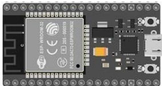
Gambar 2.8 NodeMCU ESP32 (Beretas, 2018).
