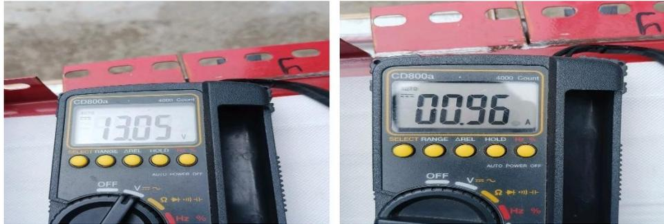
Gambar 4.11 Pengukuran Pada Pukul 11.00 Wib Pada Saat Pengujian Pengisian Baterai Menggunakan Panel Surya Tanggal 21 Februari 2025
