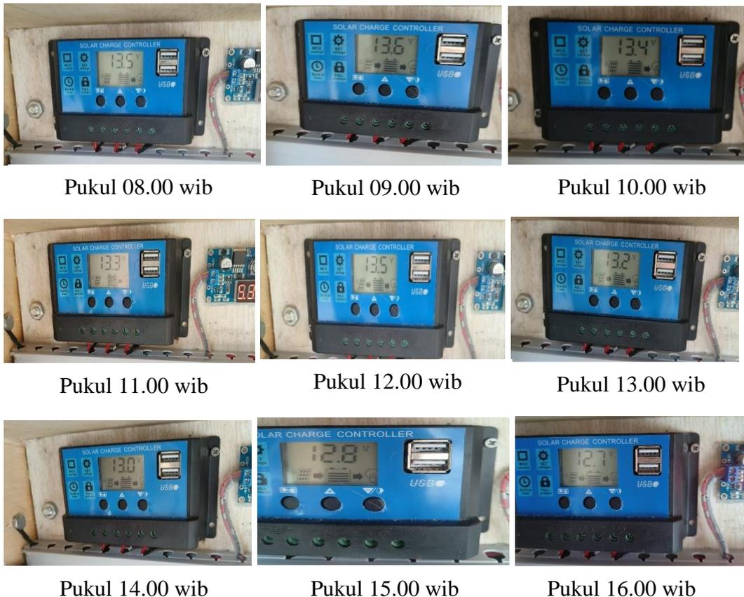
Gambar 4.20 Indikator Baterai Pada Pengujian Sistem Keseluruhan Mulai Pukul 08:00 Wib Sampai 16:00 Wib
