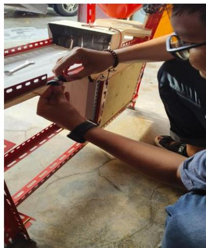
Gambar 4.82 Proses Pemasangan Motor Servo
