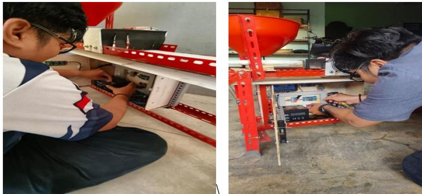
Gambar 4.84 Proses Pemasangan Baterai Dan Perakitan Arduino
