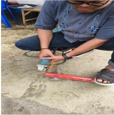
Gambar 4.74 Proses Pemotongan Rangka
