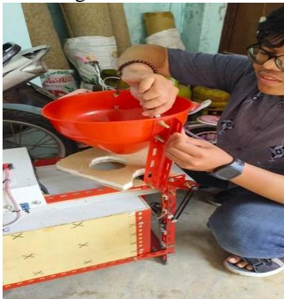
Gambar 4.79 Proses Pemasangan Corong
