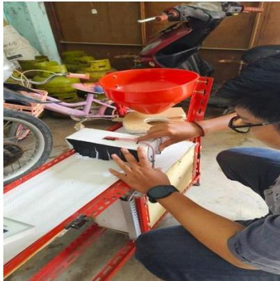
Gambar 4.80 Pemasangan Sensor Warna
