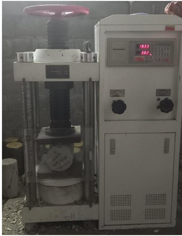
Gambar 4. 9 : Pengujian kuat tarik beton dengan mesin kuat tekan beton dan plat besi
