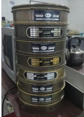
Gambar L.4 Saringan Agregat Halus
