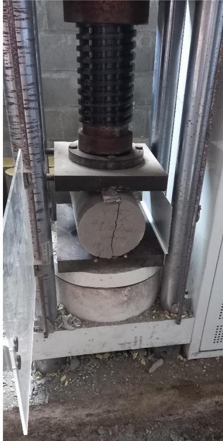
Gambar L. 14 Pengujian Kuat Tarik Beton dengan Mesin Kuat Tekan Beton dan dengan bantuan Plat Besi
