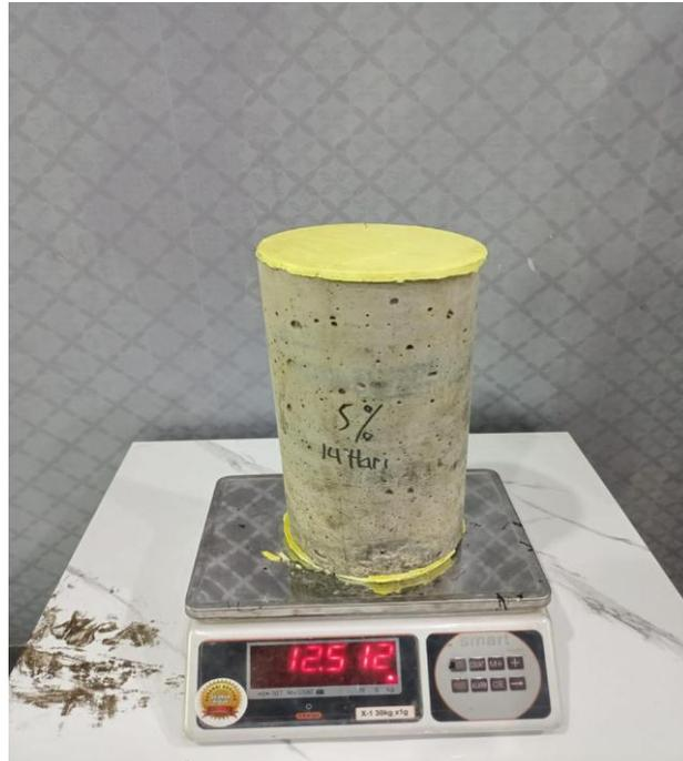
Gambar L6: Proses Pengujian Kuat Tekan Beton
