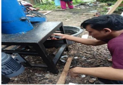
Gambar 4.16 Proses Pengujian dengan Tachometer
