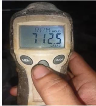
Gambar 4.6 Kecepatan putaran cetakan pelet
