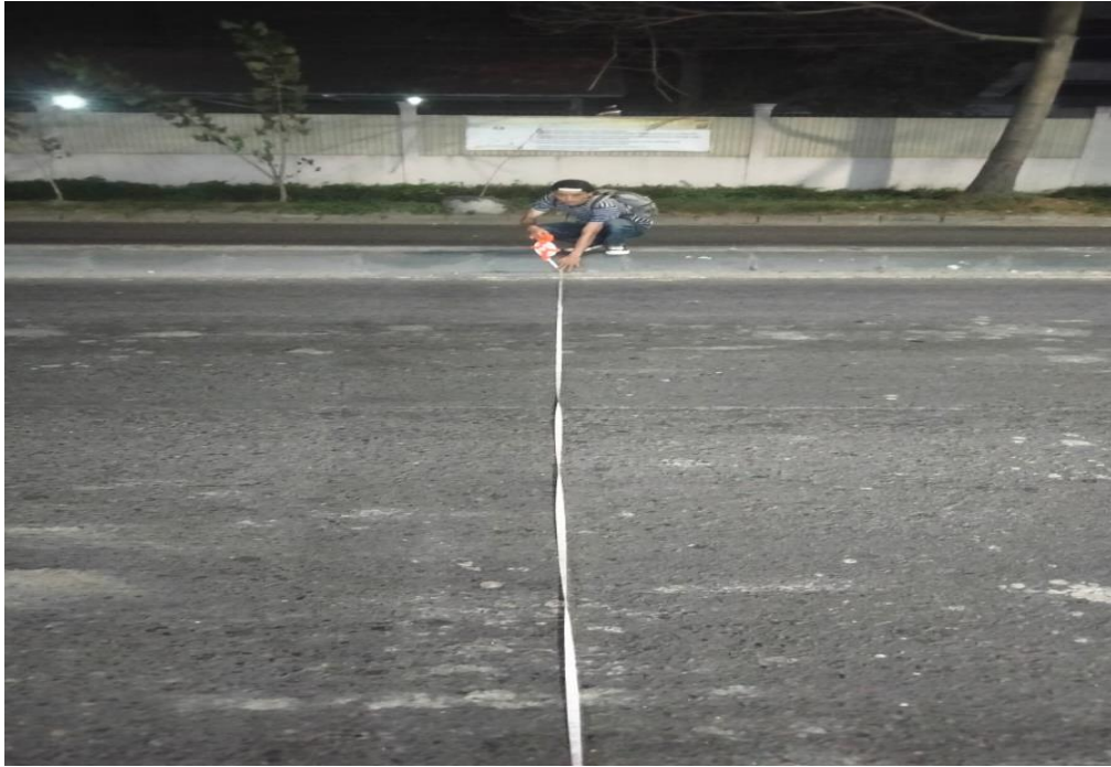
Gambar L. 7 Pengukuran lebar jalan
