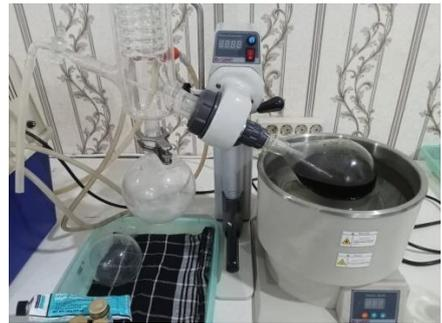
Proses pemurnian ekstraksi dengan alat rotary evaporator
