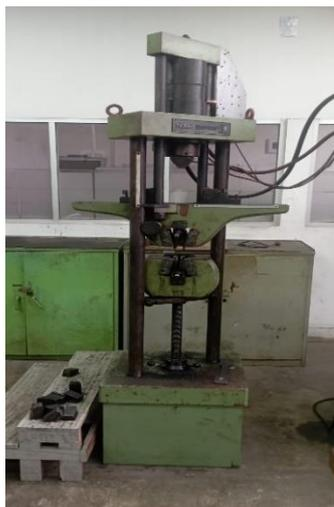
Gambar 3.2 Mesin Uji *Tensile Test*
