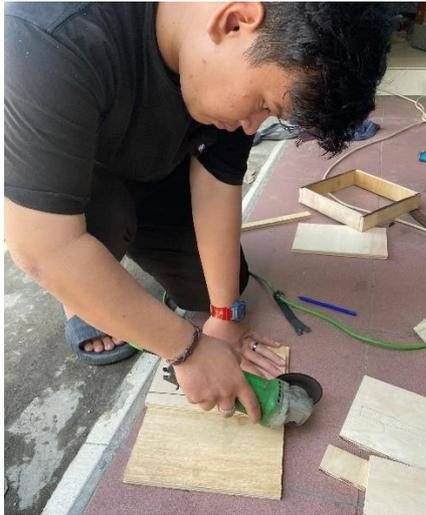
Gambar 4. 8 Proses Pemotongan Kayu Triplek
