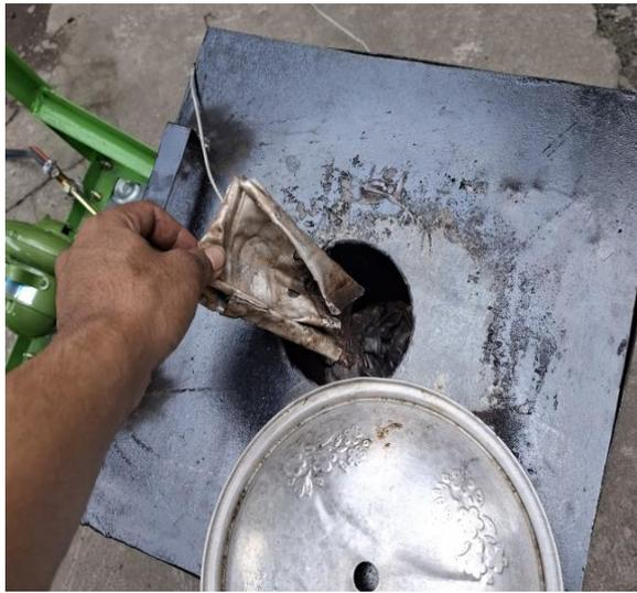
Gambar 4. 21 Memasukkan Aluminium Bekas Untuk Dilebur
