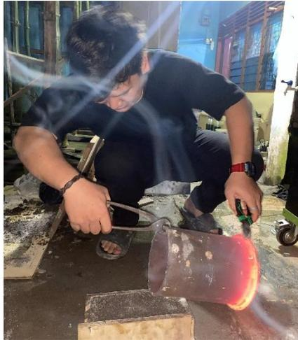
Gambar 4. 23 Proses Penuangan Aluminium Cair Kedalam Cetakan
