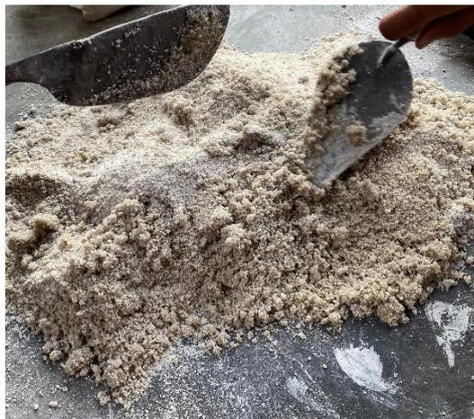
Gambar 4. 13 Proses Pencampuran Pasir dan *Bentonit*
