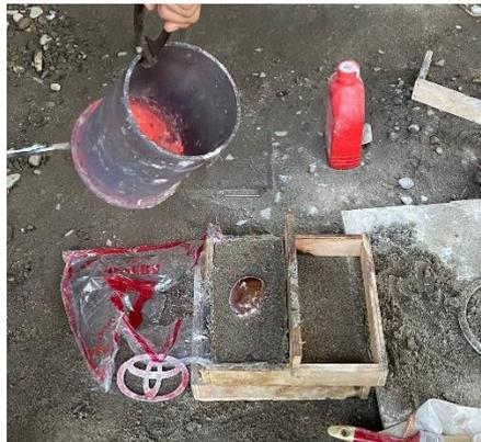
Gambar 4. 24 Cetakan Yang Suda Dituang Cairan Aluminium
