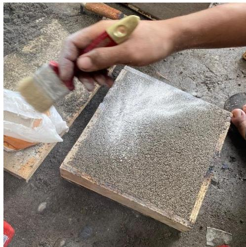
Gambar 4. 15 Proses Penaburan *Bentonit* Diatas Cetakan Pasir
