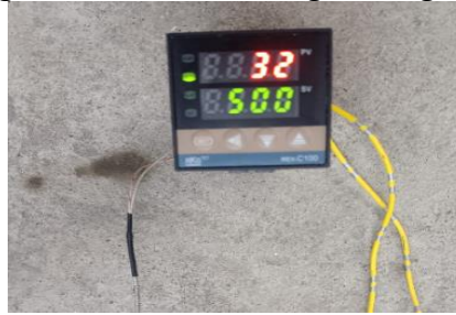
Gambar 4.7 Pengukuran Suhu Luar Tungku
