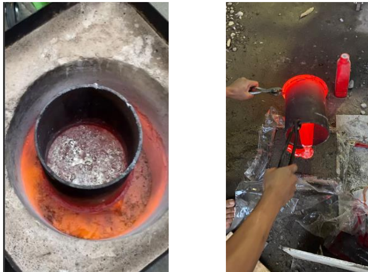
Gambar 4.9 Hasil Peleburan Alumunium
