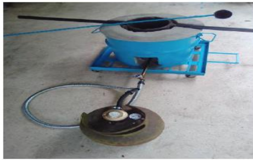
Gambar 2.1 Tungku Peleburan (Vol 2020)
