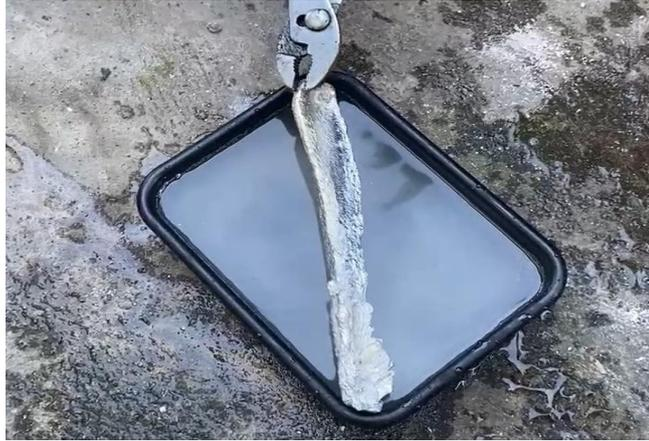
Gambar 4.21 Proses Pendinginan Dengan Larutan Air Garam
