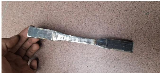
Gambar 4.7 Mal Cor Spesimen Uji Tarik
