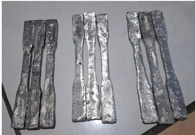
Gambar 4.27 Spesimen Siap Uji
