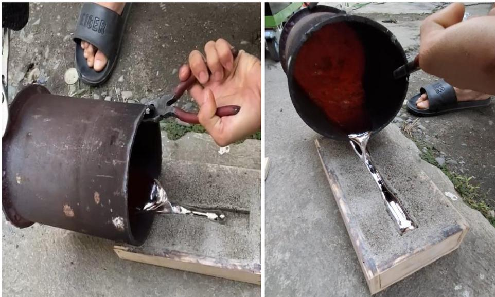
Gambar 4.19 Proses Penuangan Aluminium Cair Kedalam Cetakan
