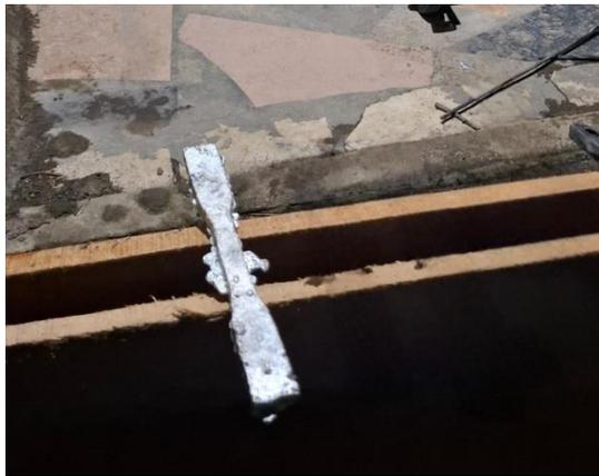
Gambar 4.23 Proses Pendinginan Dengan Udara
