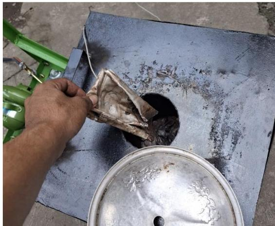
Gambar 4.17 Proses Memasukan Aluminium Rongsok ke Dalam Kowi
