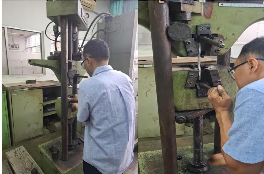
Gambar 4.29 Pemasangan Spesimen Ke Mesin Uji Tarik
