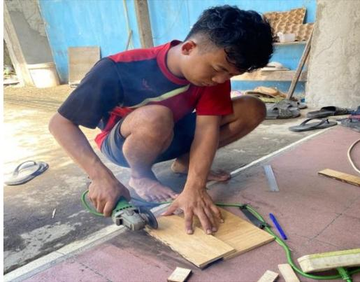
Gambar 4.2. Proses Pemotongan Triplek
