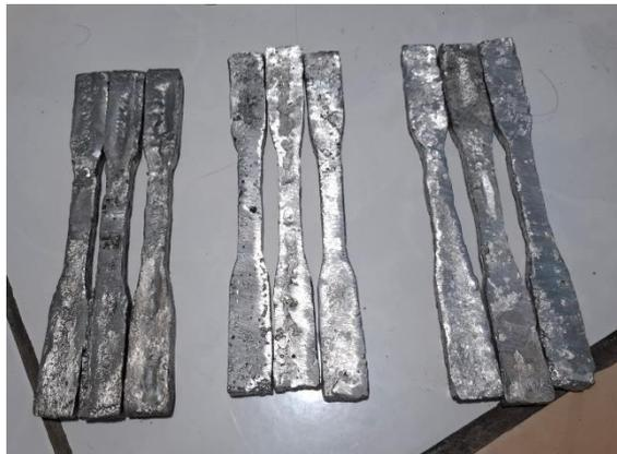
Gambar 4.1. Spesimen Uji Tarik
