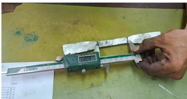
Gambar 4.28 Pengukuran Penampang Putus Spesimen
