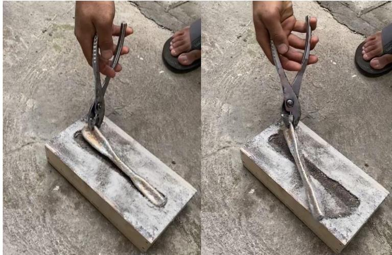
Gambar 4.20 Proses Pembongkaran Cetakan
