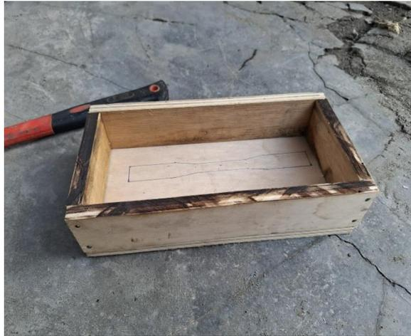
Gambar 4.5. Moulding Atau Cetakan
