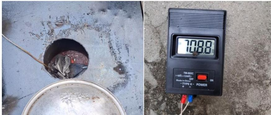
Gambar 4.16 Proses Pengukuran Temperatur Dalam Kowi
