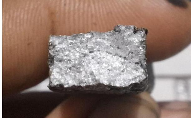
Gambar 4.34 Struktur Spesimen Oli Bekas
