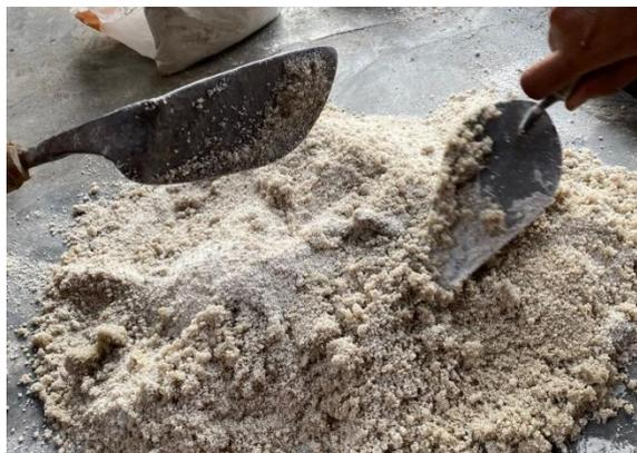
Gambar 4.10 Pencampuran Pasir Cetak
