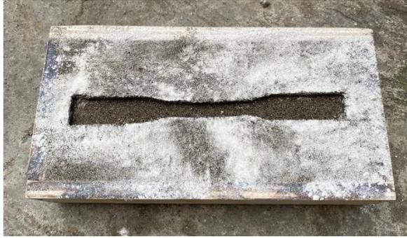
Gambar 4.11 Cetakan Pasir Spesimen Uji Tarik
