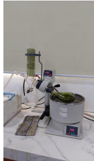
proses pemisahan etanol menggunakan rotary evaporator
