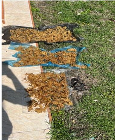
Gambar 4.3 proses penjemuran serat yang telah di lakukan perlakuan alkali
