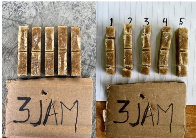
Gambar 4.9 Sebelum dan sesudah pengujian Impak dengan perlakuan alkali selama 3 jam perendaman
