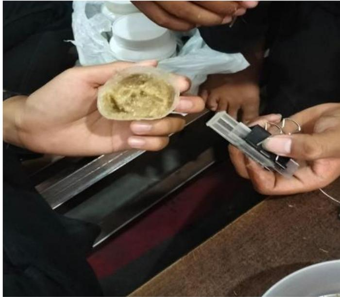
Gambar 4.7 proses penuangan campuran resin dan serat ke dalam cetakan ASTM E23
