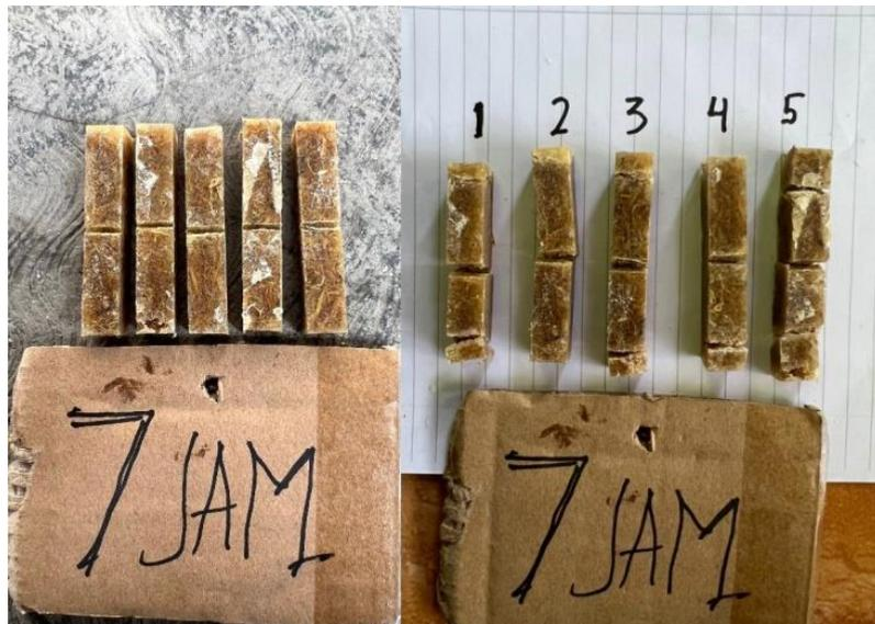
Gambar 4.11 Sebelum dan sesudah pengujian Impak dengan perlakuan alkali selama 7 jam perendaman
