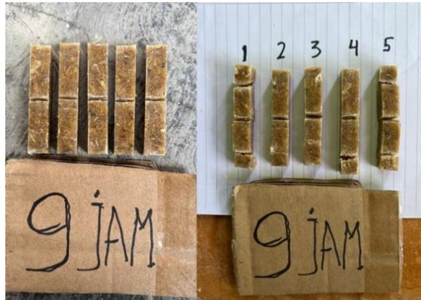
Gambar 4.12 Sebelum dan sesudah pengujian Impak dengan perlakuan alkali selama 9 jam perendaman dengan
