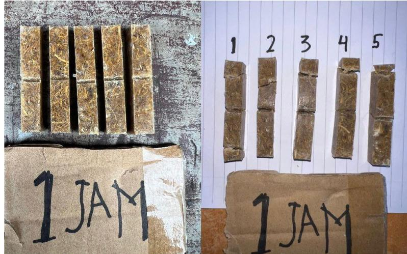
Gambar 4.8 Sebelum dan Sesudah pengujian Impak dengan perlakuan alkali selama 1 jam perendaman
