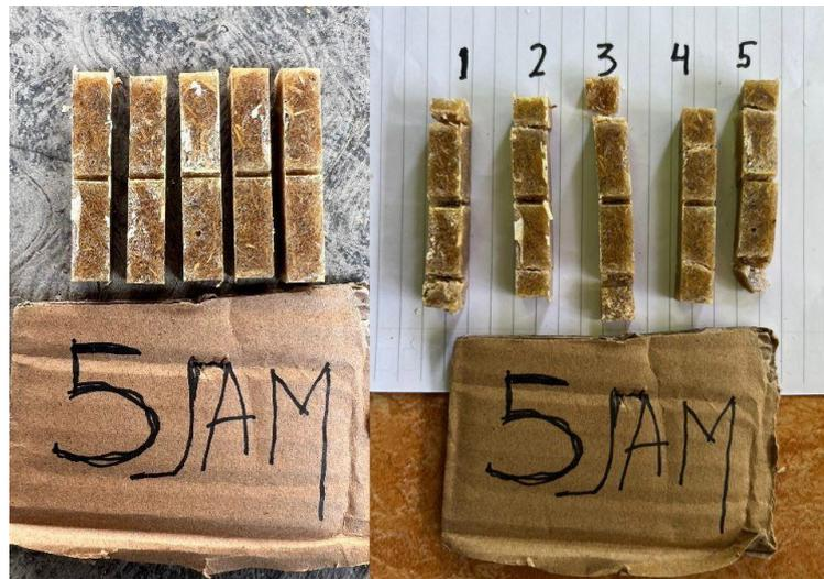
Gambar 4.10 Sebelum dan sesudah pengujian Impak dengan perlakuan alkali selama 5 jam perendaman
