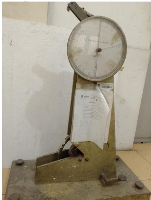
Gambar 3.12.Alat uji impak
