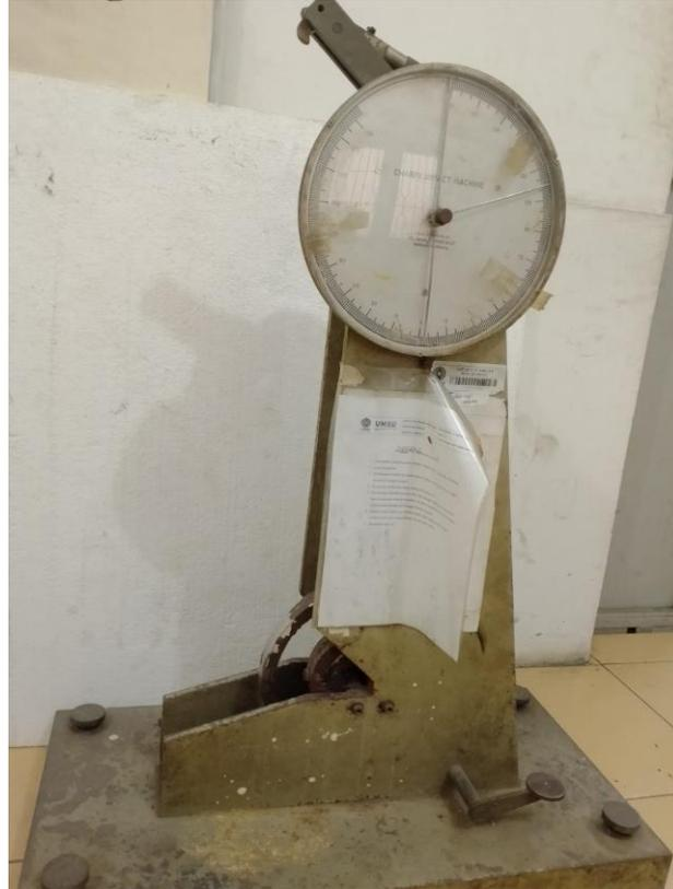
Gambar 3.9 Mesin uji impak
