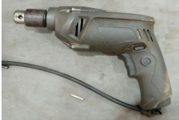
Gambar 3.6. Mesin Bor Tangan
