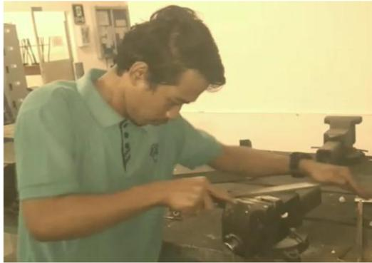
Gambar 3.25. Proses Pengikiran Spesimen
