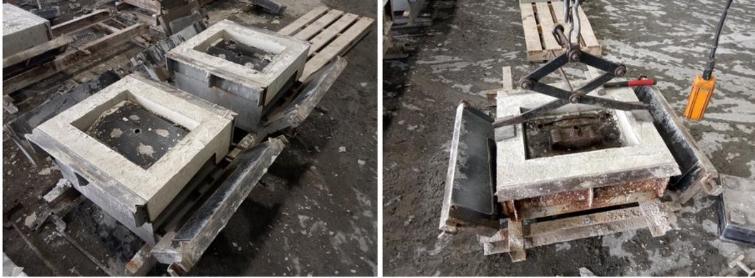
Gambar 4.6: Proses pembukaan dan pengangkatan beton dari cetakan.
