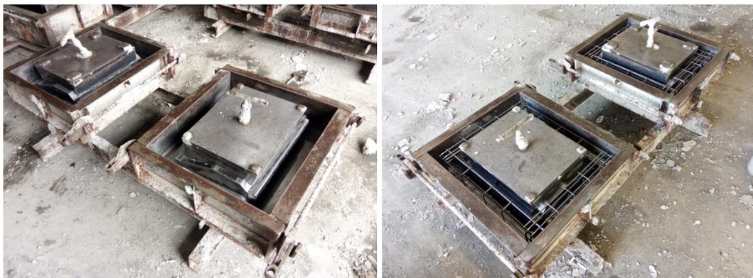
Gambar 3.15: Penutupan atau pemasangan cetakan beton.
