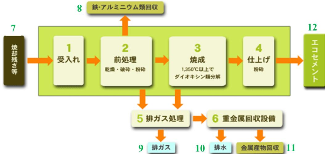
Gambar 3.6: Proses pembuatan *eco cement*.
