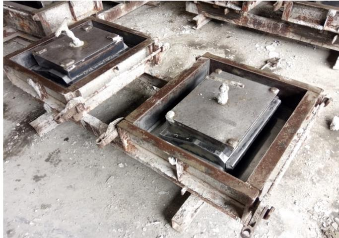
Gambar 3.11: Cetakan beton (*modal*).
