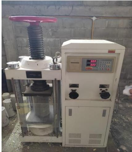
Gambar.L 19. Mesin kuat tekan (*compression test machine*)
