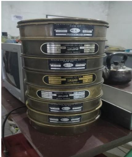
Gambar.L 5. Saringan agregat halus
