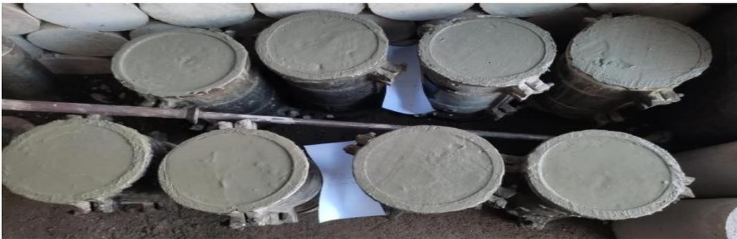
Gambar 3.4: Pembuatan beton yang sudah didalam cetakan silinder 15x30 cm
