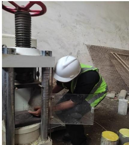
Gambar.L 24 Proses pengujian benda uji dengan menggunakan mesin kuat tekan
