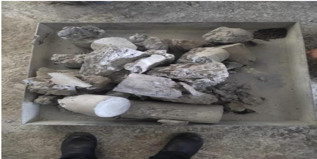
Gambar 3.3: Limbah uji beton silinder yang dipergunakan dalam penelitian.
