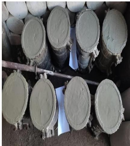
Gambar.L 20. Beton dalam wadah cetakan silinder 15x30cm
