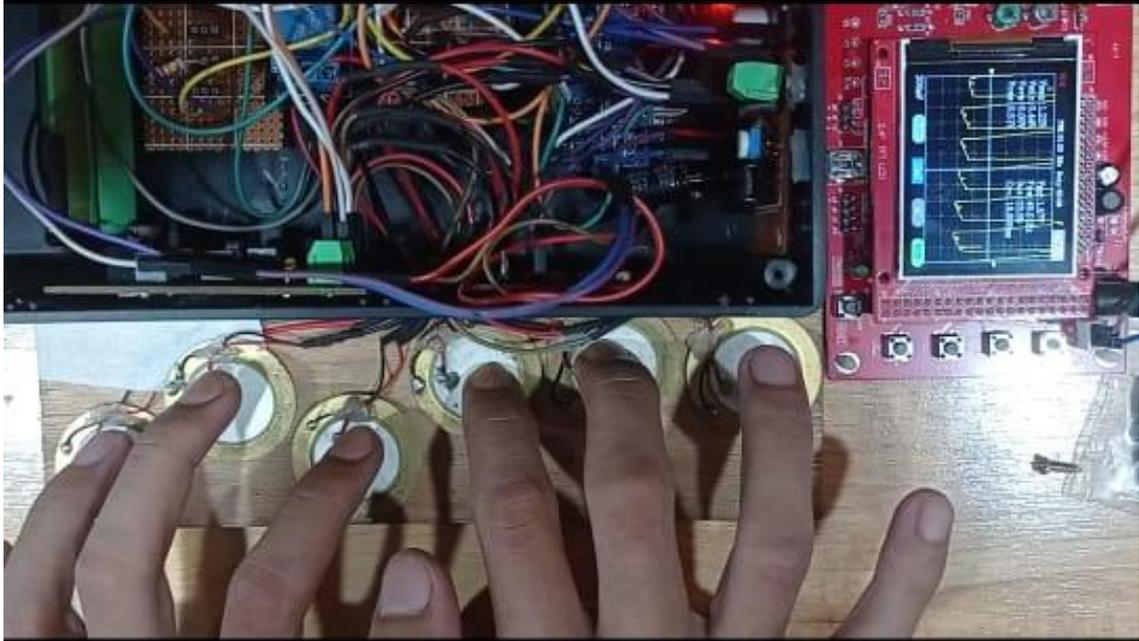
Gambar 4. 14 Pengujian rangkaian rectifier pada osiloskop.
