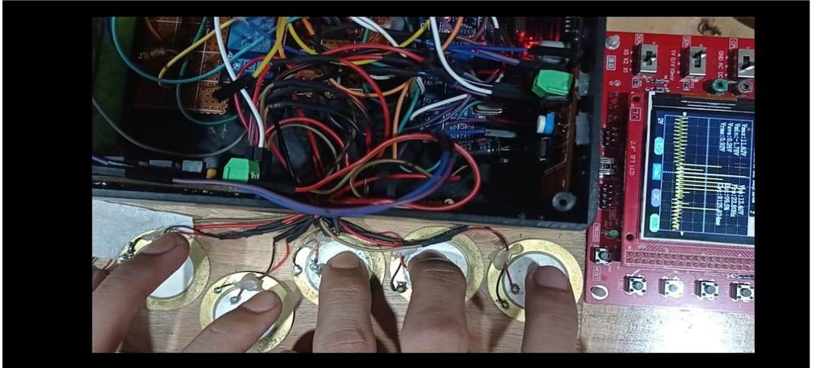
Gambar 4. 15 Pengujian step up untuk sensor piezoelektrik pada osiloskop.
