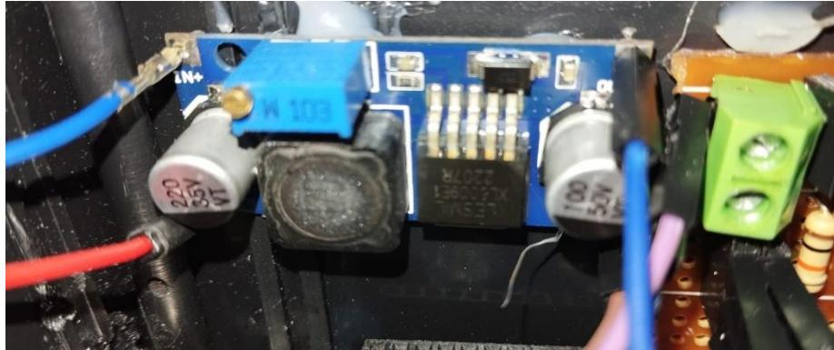
Gambar 4. 4 Penempatan modul step up pada box project.
