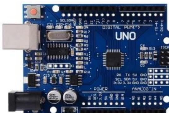
Gambar 2. 10 Bentuk fisik Arduino uno
