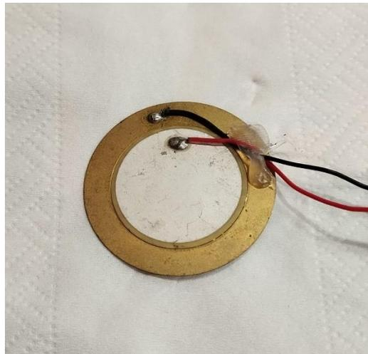
Gambar 2. 8 Sensor piezoelektrik
