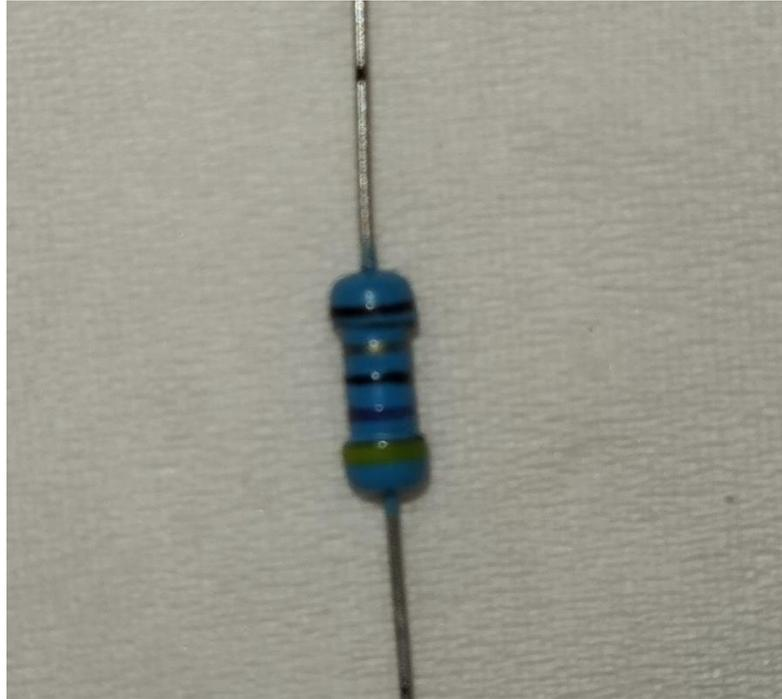
Gambar 2. 1 Bentuk fisik resistor.
