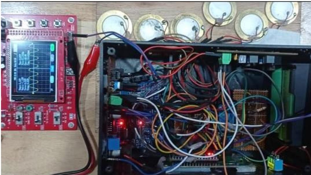
Gambar 4. 12 Output sensor piezoelektrik setelah menggunakan sinyal conditioning stage pertama pada osiloskop.
