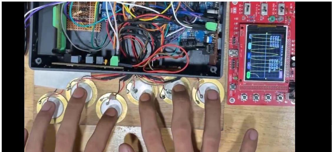
Gambar 4. 10 Output sensor piezoelektrik pada osiloskop.
