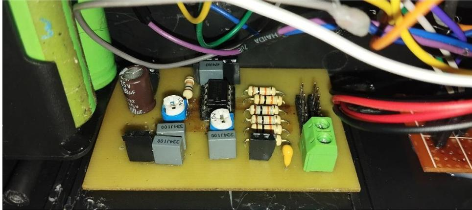
Gambar 4. 1 Hasil pembuatan sinyal conditioning stage pertama
