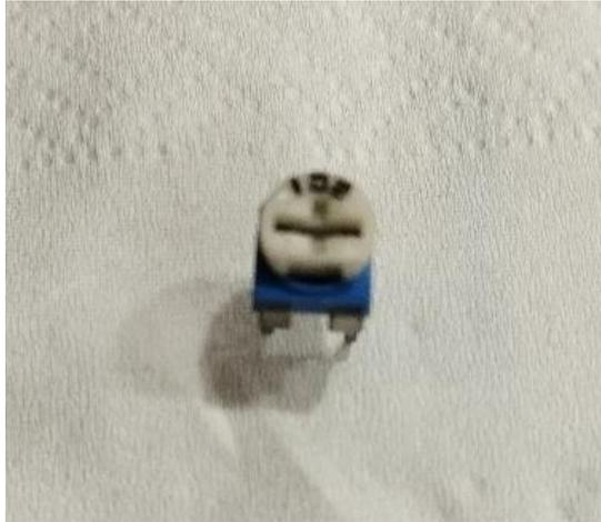
Gambar 2. 2 Bentuk fisik resistor variable.
