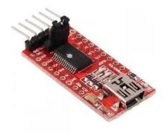
Gambar 2. 14. FTDI USB Converter
