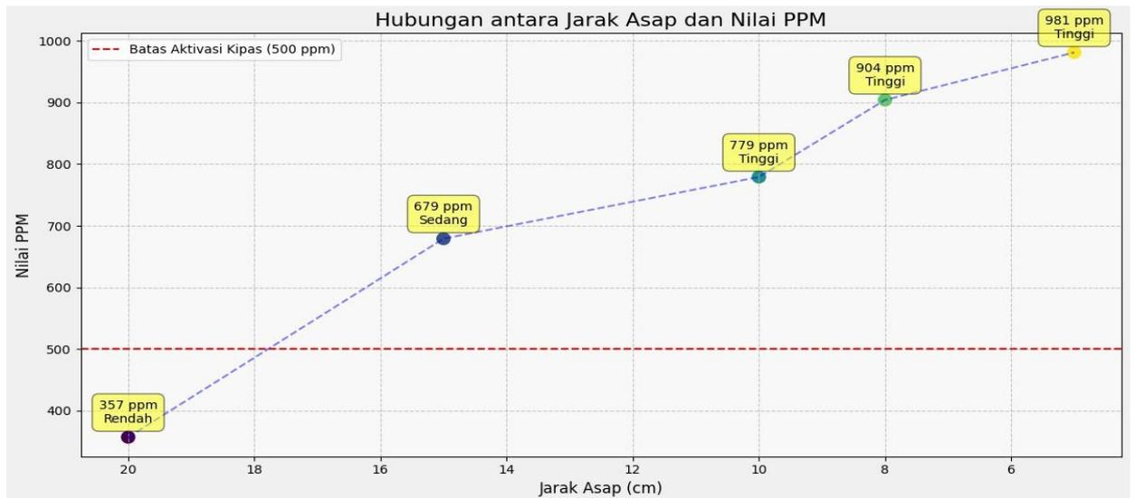
**Gambar 4. 5 Data Pengujian Sensor Asap terhadap jarak**
