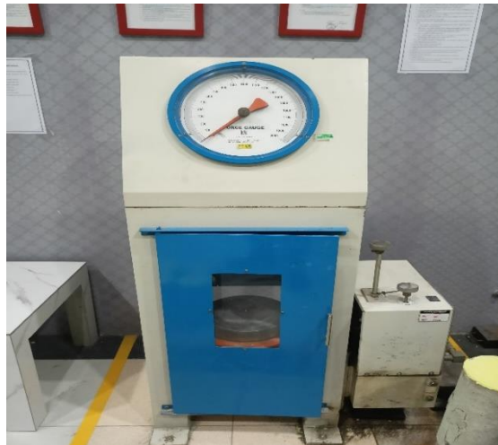
Gambar 2.4: Alat pengujian kuat tekan beton.
