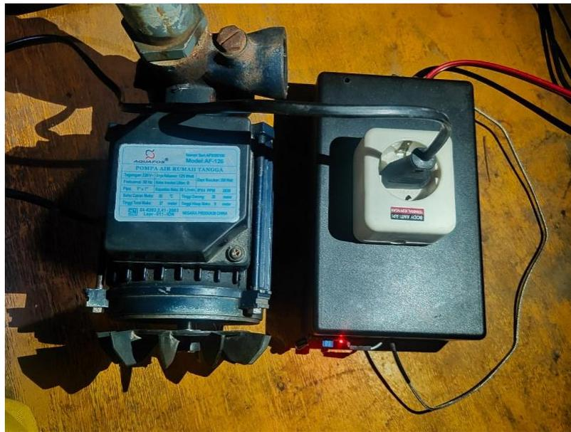
Gambar 4.11 Pengujian RPM Motor Dengan Beban
