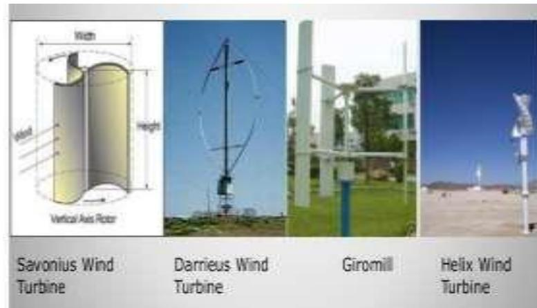
Gambar 2.3 Turbin Vertikal
