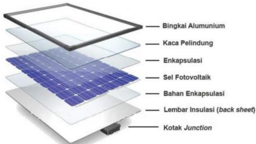
Gambar 2.18. Struktur material panel surya.
