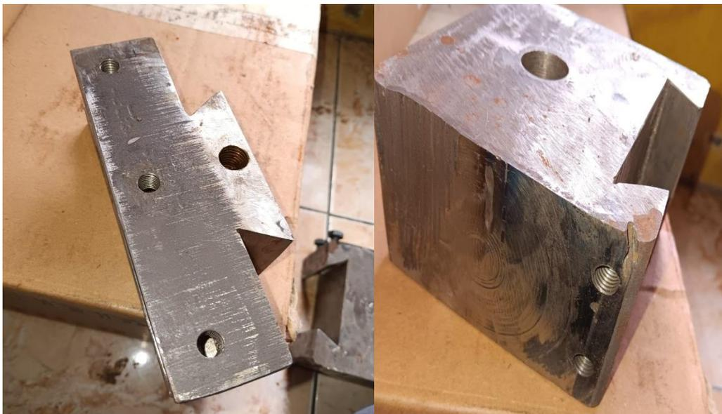
Gambar 4.14 Hasil proses pengetapan
