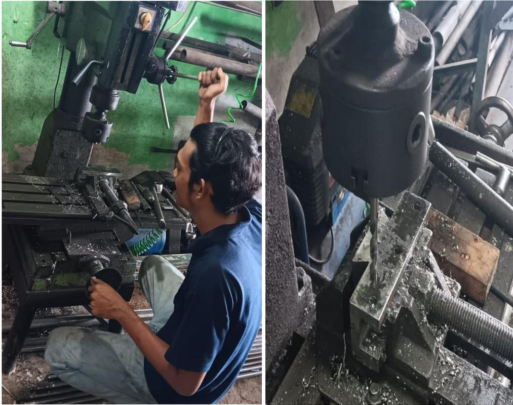
Gambar 4.11 Proses pengeboran lubang mur penahan pahat dan lubang pengatur ketinggian pahat
