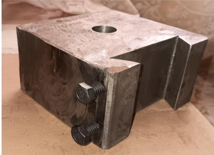
Gambar 4.8 hasil pembuatan *Toolpost*
