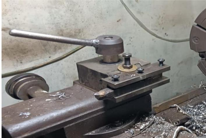
Gambar 4.2 *Quick change toolpost* yang telah dikembangkan
