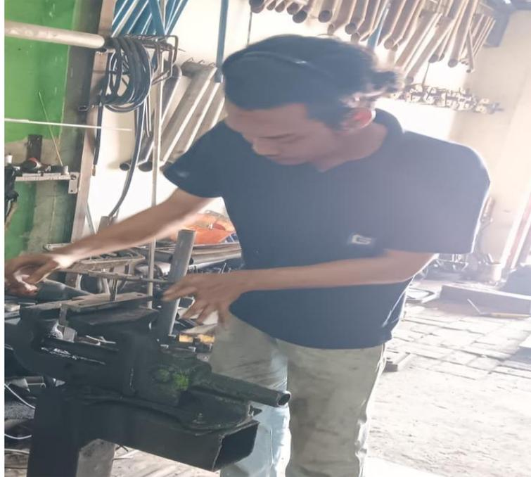
Gambar 4.13 Proses pengetapan
