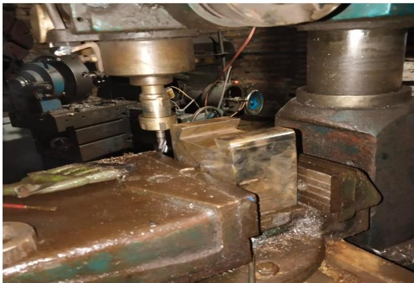
Gambar 4.7 Pembuatan *toolpost*
