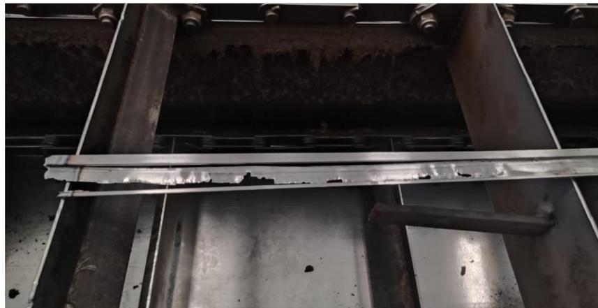
Gambar 4.8 Fisik Liner yang mengalami kerusakan
