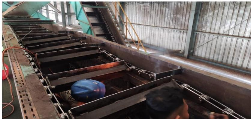
Gambar. 4.6 Penyambungan antara liner dan bucket
