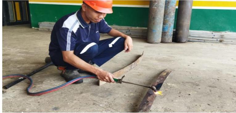
Gambar 4.2 Proses Pemanasan limbah pegas daun
