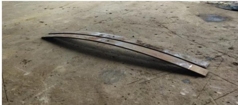
Gambar 4.1 limbah pegas daun sebelum dilakukan modifikasi
