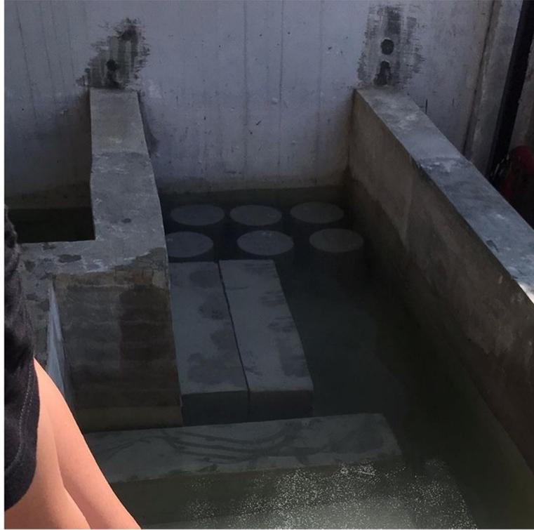
Gambar L.17 : Benda uji silinder saat perendaman
