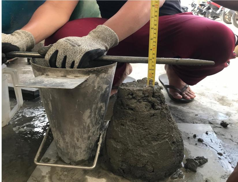
Gambar L.13 : Pengujian *slump test*
