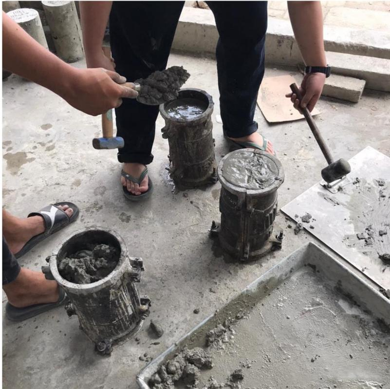
Gambar L.15 : Beton segar dimasukkan ke dalam bekisting
