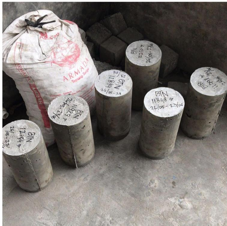
Gambar L.16 : Beton yang telah dicetak
