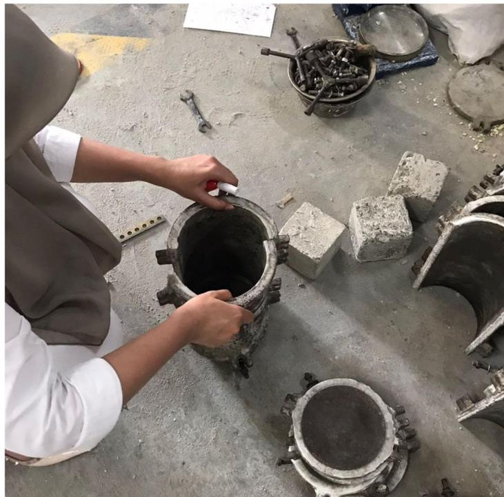
Gambar L.12 : Pemasangan bekisting
