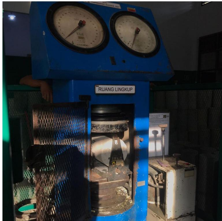
Gambar L.19 : pengujian kuat tarik belah beton
