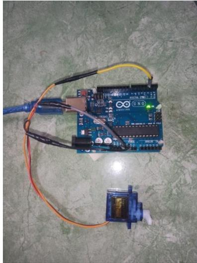
Gambar 4. 4 Pemasangan Motor Servo
