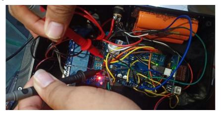
Gambar 4.5. Pengukuran Tegangan Sumber Arduino Uno
