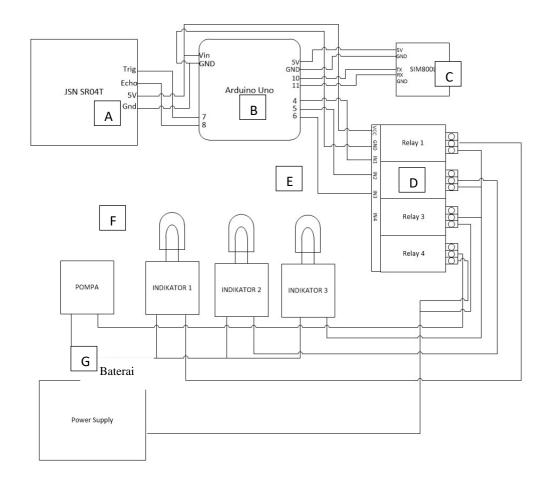
Gambar 3.6. Rangkaian Sistem Secara Keseluruhan
