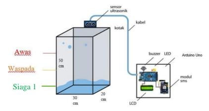
Gambar 3.2. Perancangan Perangkat Keras dari Sistem
