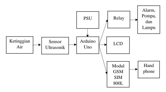
Gambar 3.1. Blok Diagram Kerja Sistem Pendeteksi Pendeteksi Banjir Otomatis Dengan Level Standar Siaga 1, Waspada Dan Awas Berbasis GSM Sebagai SMS Gateway Dengan Pengingat Alarm
