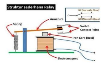
Gambar 2.15. Gambar Bagian - Bagian dari Relay (AMALIA, 2020)
