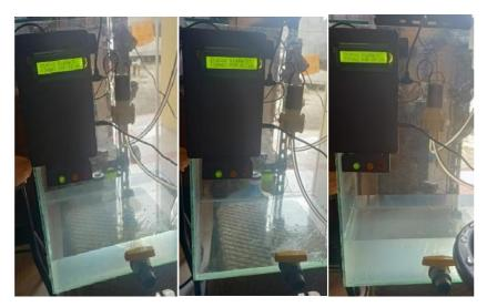
Gambar 4.8. Status Banjir Siaga 1, Ketinggian Air pada LCD dan Indikator Lampu Hijau
