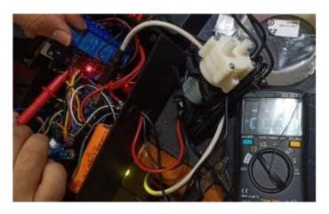
Gambar 4.6. Pengukuran Tegangan Pada Relay
