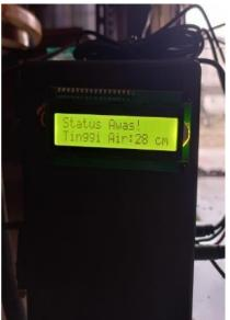
Gambar 4.11. Status Banjir Waspada, Ketinggian Air pada LCD dan Indikator Lampu Merah
