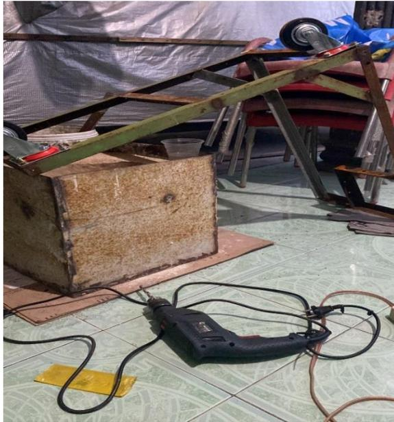
Gambar 4.5 Pemasangan Roda Pada Rangka
