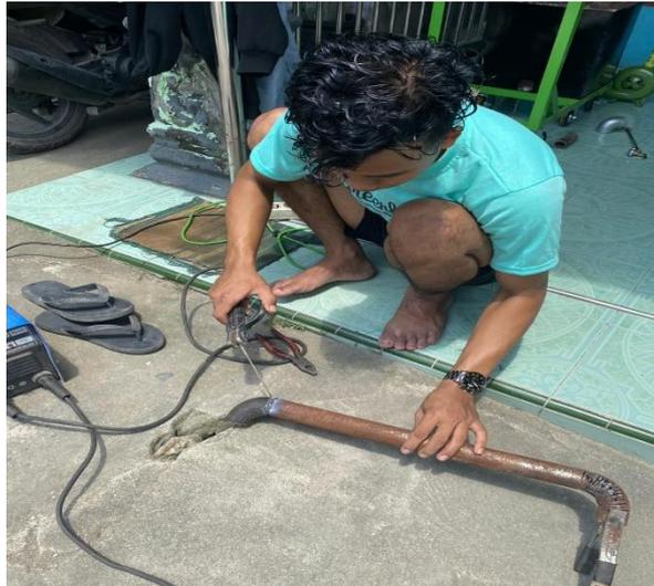
Gambar 4.14 Proses Pembuatan Pipa Burner
