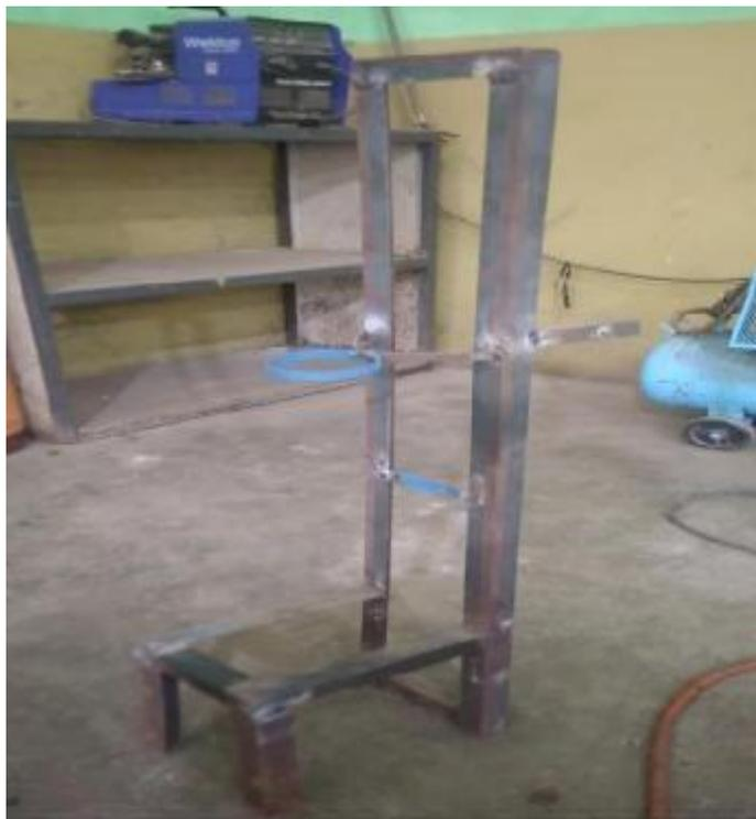
Gambar 4.19 Hasil pengelasan rangka
