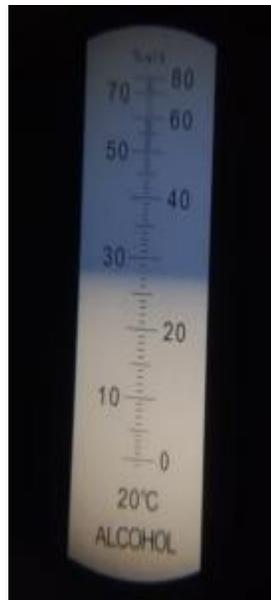
Gambar 4.29 Konsentrasi setelah uji separator
