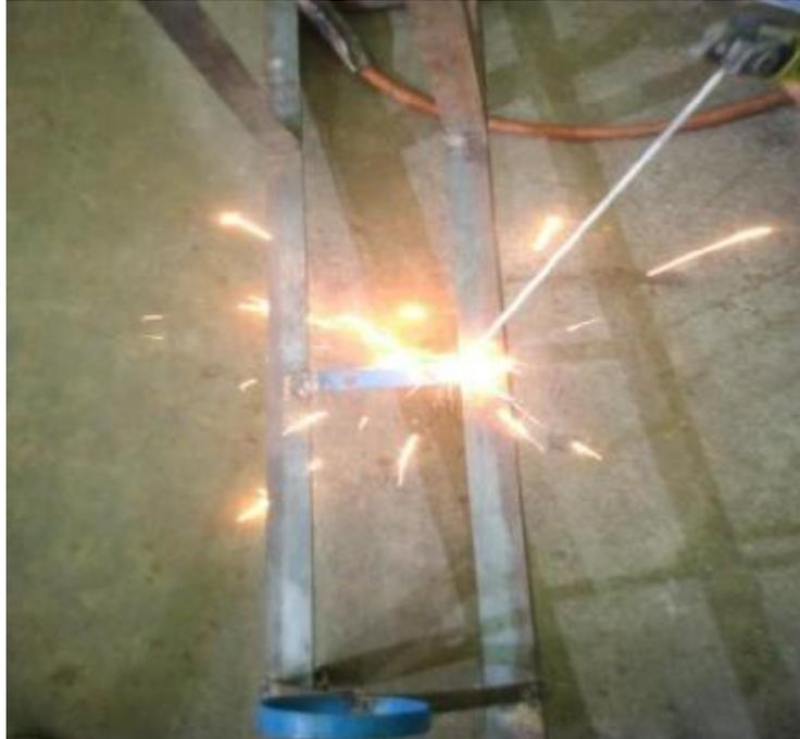
Gambar 4.18 Pengelasan bagian dudukan separator
