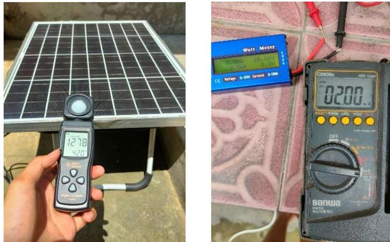
Gambar 4. 5 Intensitas, Tegangan, dan Arus Pada Panel Surya Tanpa Beban
