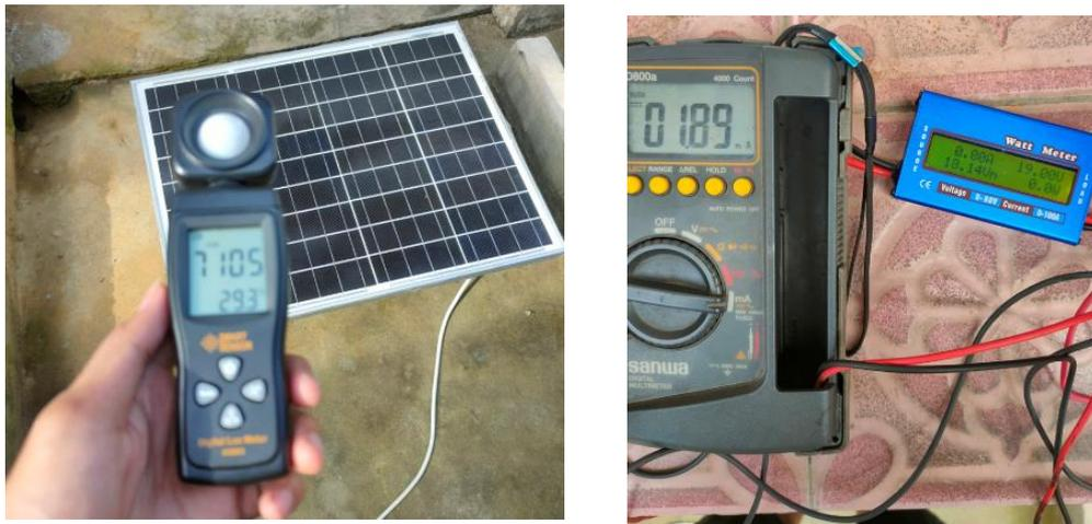
Gambar 4. 7 Intensitas, Tegangan, dan Arus Pada Panel Surya Tanpa Beban
