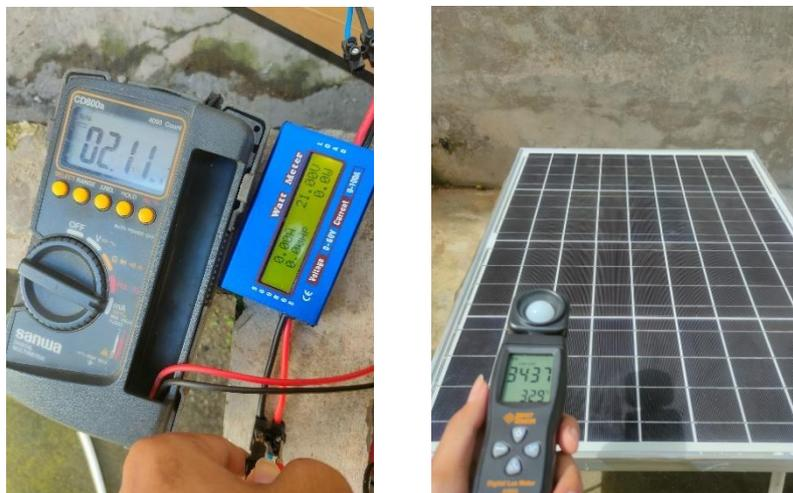
Gambar 4. 3 Intensitas, Tegangan, dan Arus Pada Panel Surya Tanpa Beban
