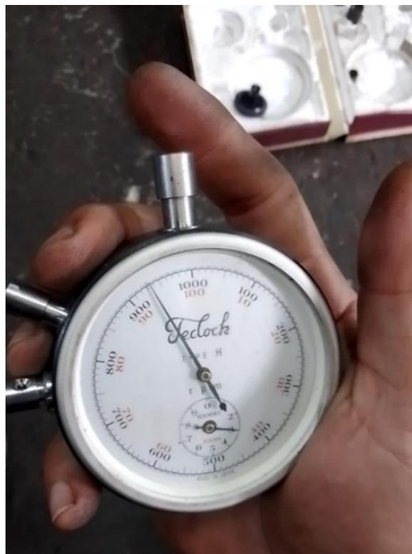
Gambar 4.21 Pengujian RPM menggunakan *Tachometer*
