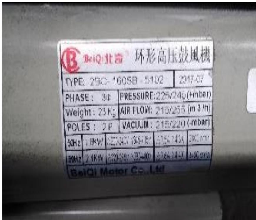
Gambar 4.1 name plate motor induksi.
