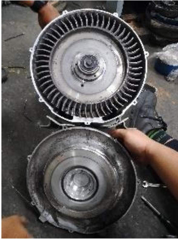
Gambar 4.4 Impeler Motor
