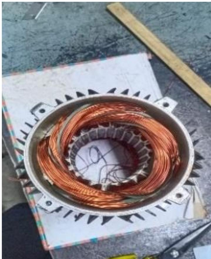
Gambar 4.13 Proses pemasangan prespan lapis.
