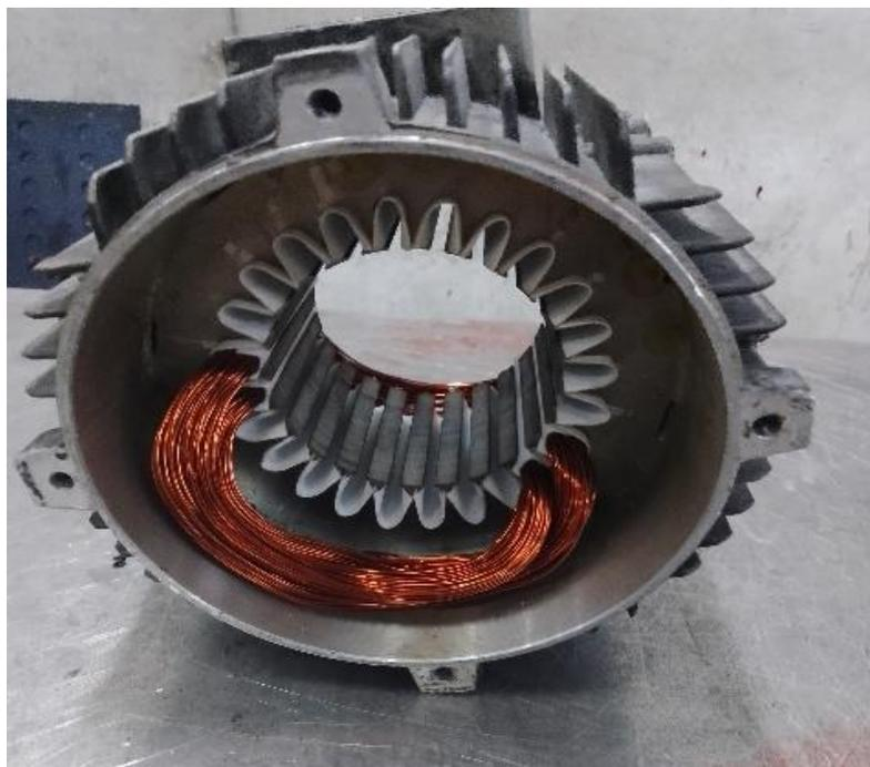
Gambar 4.12 Proses pemasangan prespan penutup
