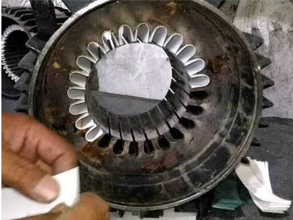
Gambar 4.9 Proses pemasangan prespan.
