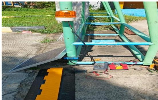
Gambar 4.2 Prototipe Hybrid System Solar Cell dan Piezoelektrik
