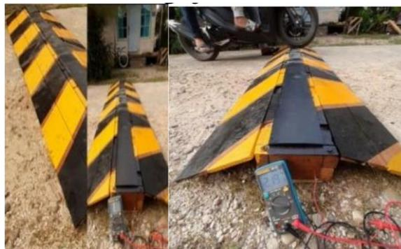
Gambar 2.22 Proses Pengujian Pembangkit Listrik Tenaga Piezoelektrik Dengan Media Speed Bumper
