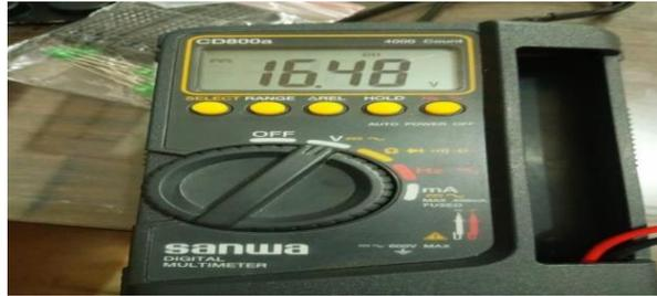
Gambar 4.5 Hasil Pengukuran Tegangan Maksimal Solar Cell 50wp
