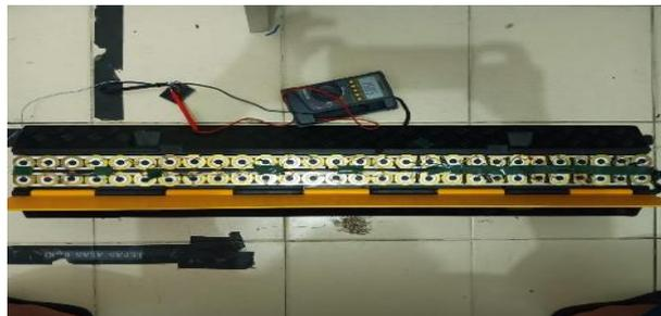
Gambar 4.1 Modifikasi Speed Bump dengan Piezoelektrik untuk Menghasilkan Energi Listrik DC
