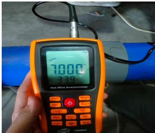
Gambar 4.34 Pengukuran Menggunakan *Hot Wire Anemometer* Di 50 Hz
