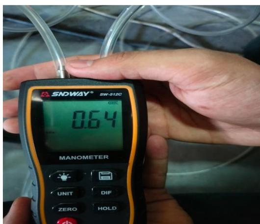
Gambar 4.32 Pengukuran Menggunakan Manometer Digital Di 40 Hz
