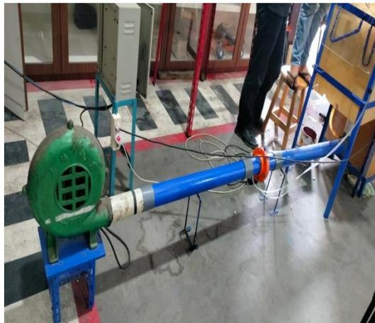
Gambar 4.21 Rangkain Pengukuran Laju Aliran Fluida
