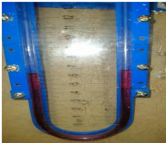
Gambar 4.24 Pengukuran Menggunakan Manometer U Di 10 Hz
