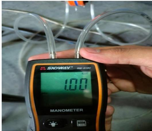
Gambar 4.35 Pengukuran Menggunakan Manometer Digital Di 50 Hz
