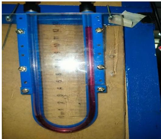
Gambar 4.36 Pengukuran Menggunakan Manometer U Di 50 Hz
