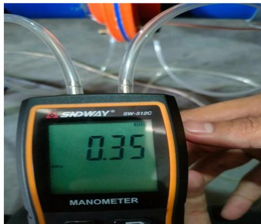
Gambar 4.29 Pengukuran Menggunakan Manometer Digital Di 30 Hz
