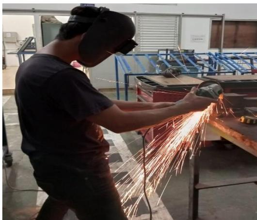
Gambar 4.9 Memotong Besi Plat *strip*
