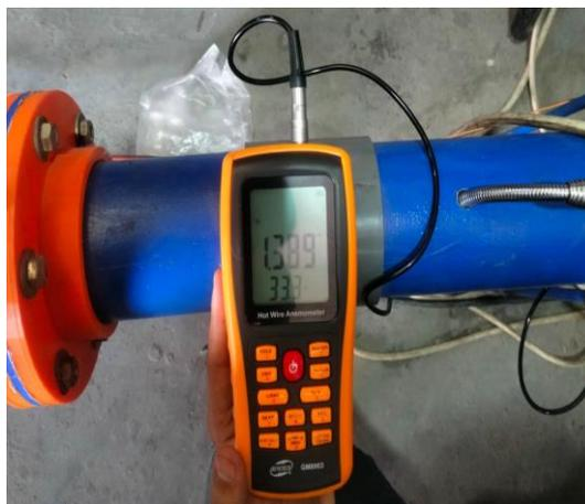
Gambar 4.22 Pengukuran Menggunakan *Hot Wire Anemometer* Di 10 Hz
