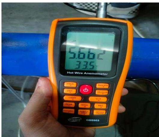
Gambar 4.31 Pengukuran Menggunakan *Hot Wire Anemometer* Di 40 Hz
