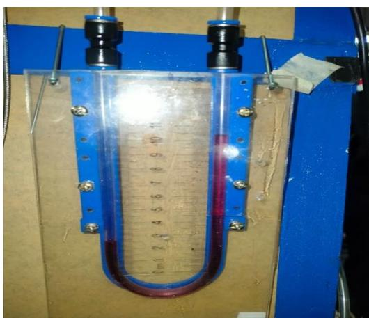
Gambar 4.33 Pengukuran Menggunakan Manometer U Di 40 Hz
