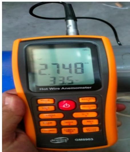
Gambar 4.25 Pengukuran Menggunakan *Hot Wire Anemometer* Di 20 Hz
