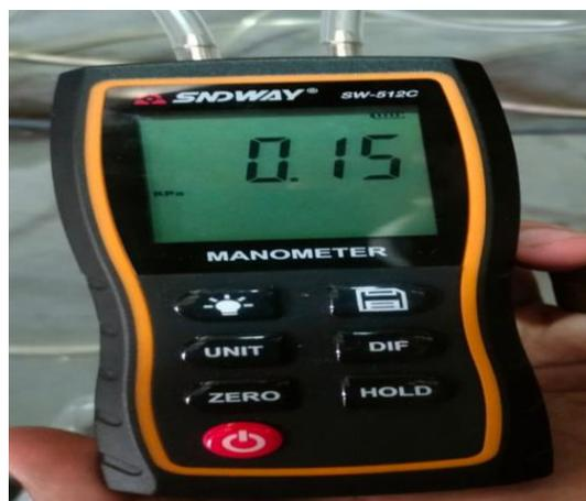
Gambar 4.26 Pengukuran Menggunakan Manometer Digital Di 20 Hz
