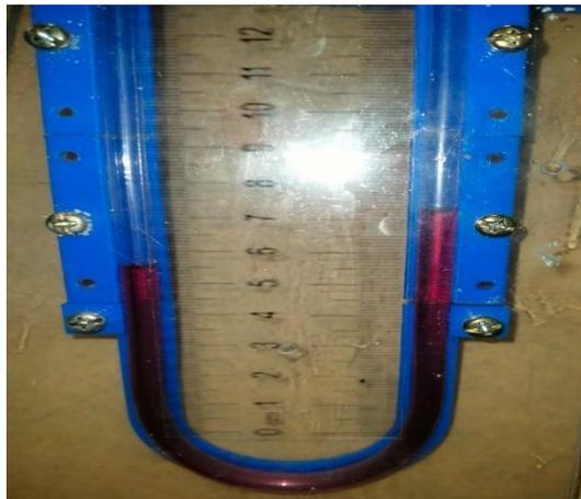
Gambar 4.27 Pengukuran Menggunakan Manometer U Di 20 Hz
