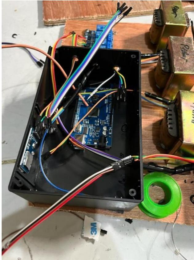
**Gambar 4. 3 Penghubungan Perangkat Ke Arduino**
