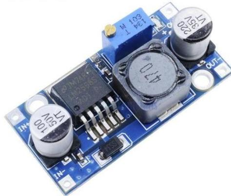
Gambar 3.3 Konverter Step down
