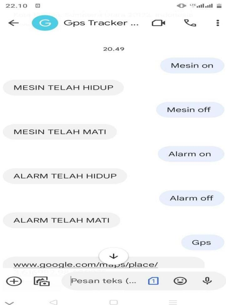
Gambar 4.3 Pengontrolan ON/OFF mesin melalui SMS
