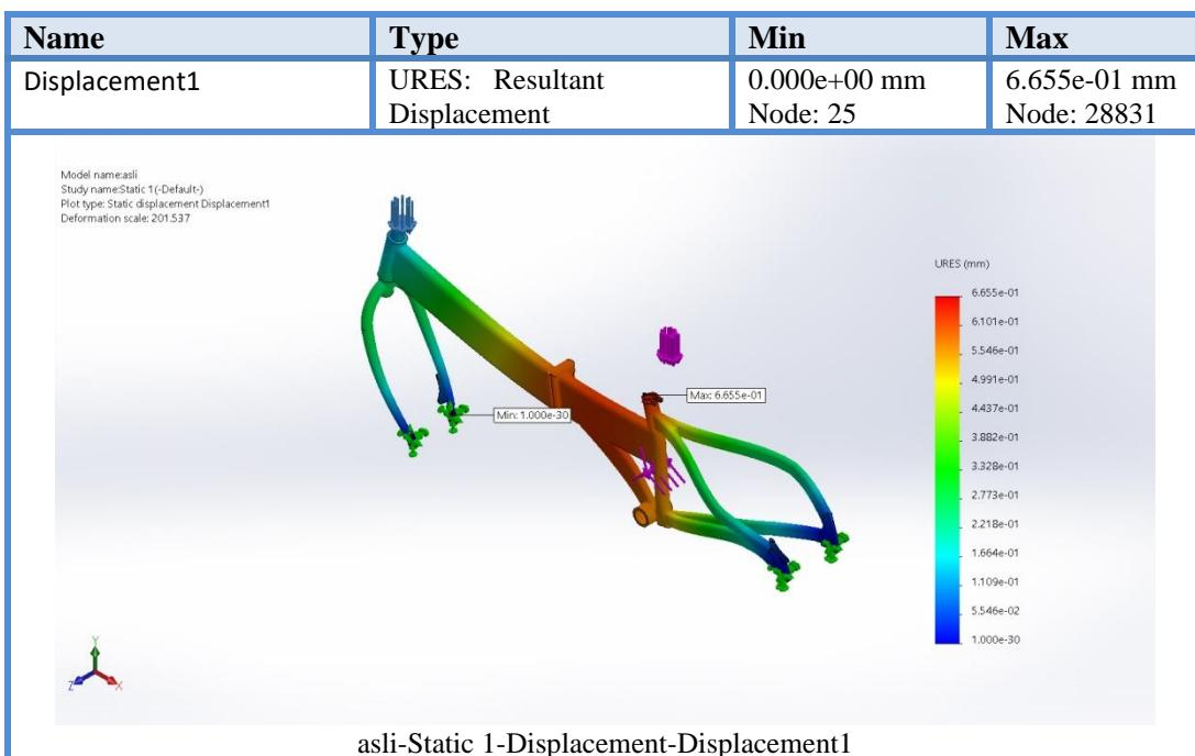
Gambar 4.45 Hasil Analisa Beban Maksimal *Displacement* Pada Sepeda Lipat Dengan Beban 1015 Kg
