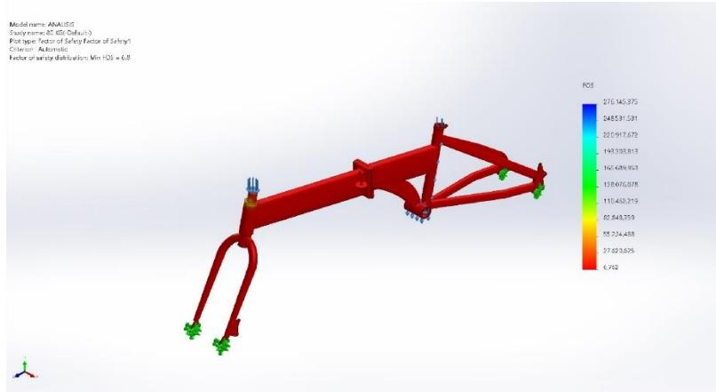
Gambar 4.42. Hasil analisa simulasi *safety factor* pembebanan rangka sepeda lipat dengan beban 120 kg
