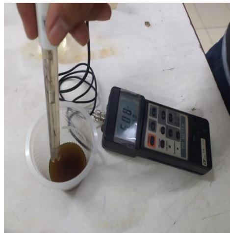
Gambar 14. Uji Parameter pH
