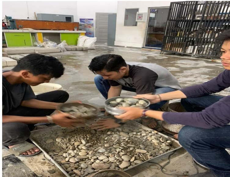
Lampiran 3: Pengujian Analisa Saringan Agregat Kasar
