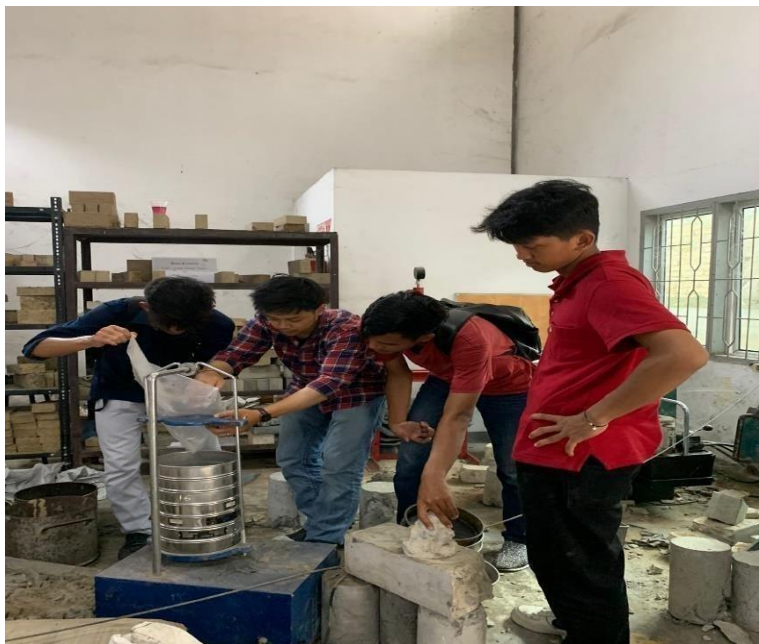
Lampiran 2: Pengujian Analisa Saringan Agregat Halus
