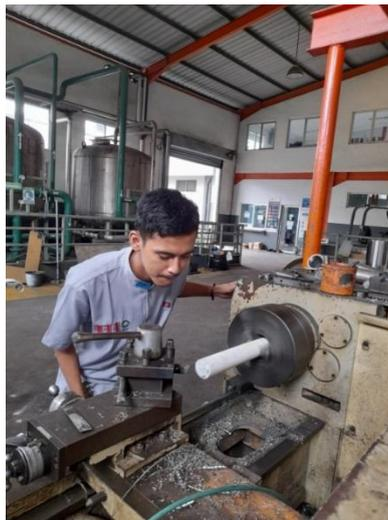
Gambar 4. 4. Proses Pembubutan Roll Teflon Conveyor Otomatis
