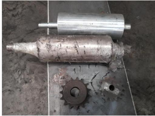
Gambar 4. 5. Roll Dan Sproket Penggerak
