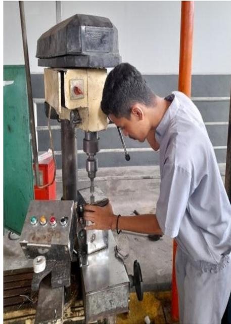
Gambar 4. 10. Proses Pengeboran Lubang Lampu Indikator
