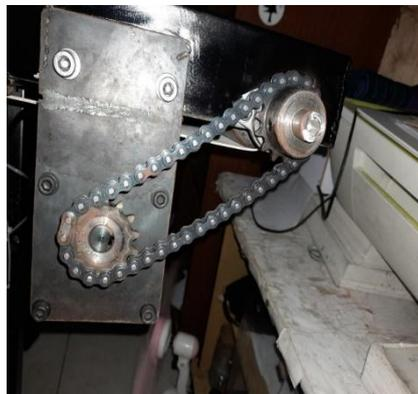
Gambar 4. 9. Sistem Penggerak Conveyor Otomatis
