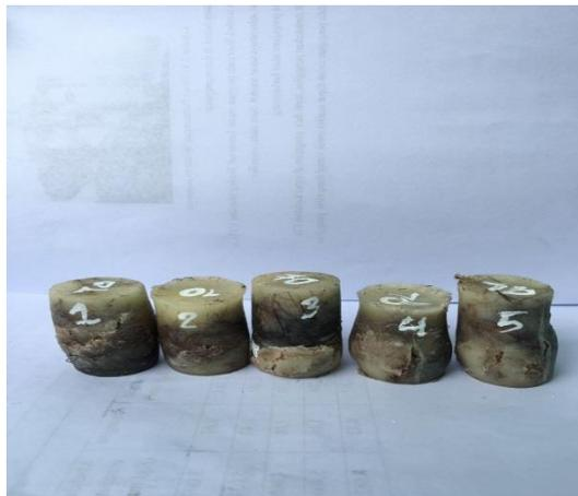
Gambar 4.3 Bentuk Spesimen Hasil Dari Pengujian Tekan 70 Gram Resin : 15 Gram Serat durian 15 Gram Serat ijuk
