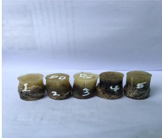
Gambar 4.4 Bentuk Spesimen Hasil Dari Pengujian Tekan 80 Gram Resin : 10 Gram Serat durian 10 Gram Serat ijuk
