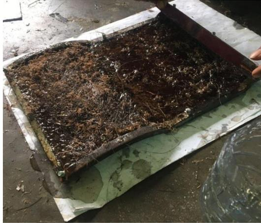
Gambar 3.41 Penyusunan Serat Ijuk Dan Durian Kedalam Cetakan
