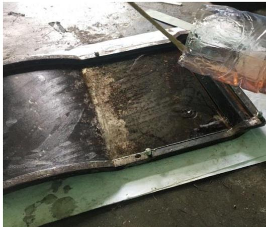
Gambar 3.40 Penuangan Resin Kedalam Cetakan Atap
