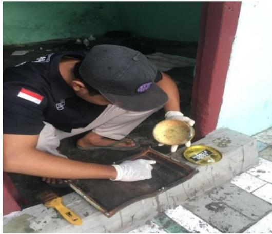
Gambar 3.35 Proses Pemberian *Wax* Pada Cetakan Atap
