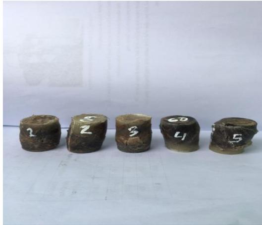
Gambar 4.2 Bentuk Spesimen Hasil Dari Pengujian Tekan 60 Gram Resin : 20 Gram Serat durian 20 Gram Serat ijuk
