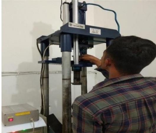
Gambar 3.46 Proses Pemasangan Spesimen *compress*
