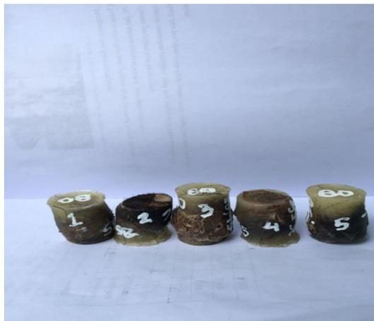
Gambar 4.5 Bentuk Spesimen Hasil Dari Pengujian Tekan 80 Gram Resin : 10 Gram Serat durian 10 Gram Serat ijuk
