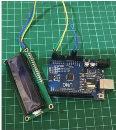
Gambar 4.5 LCD ke Arduino
