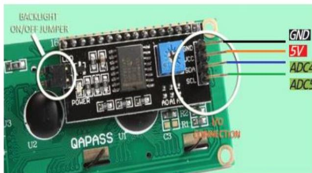
Gambar 2.12. Konfigurasi PIN LCD
