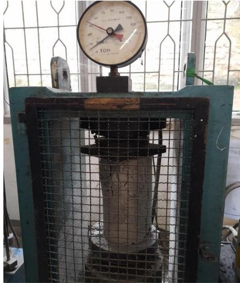
Lampiran 33: Proses Pengujian Beton
