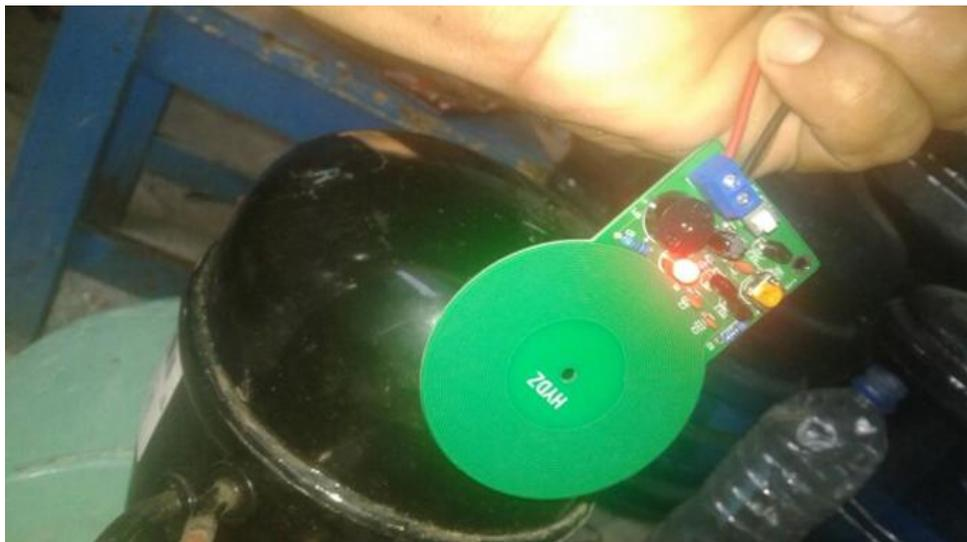
Gambar 3.3 : metal setelah dirakit dan di uji coba ke logam (kompresor kulkas)
