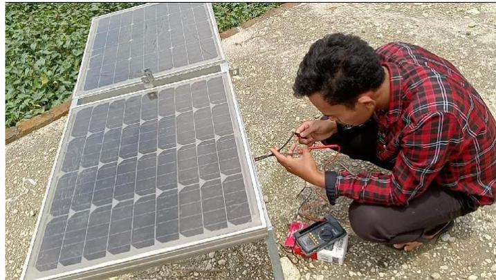
Gambar 2: Pengukuran PLT Monocrystalline dan polycrystalline dengan kaca film VLT 75%
