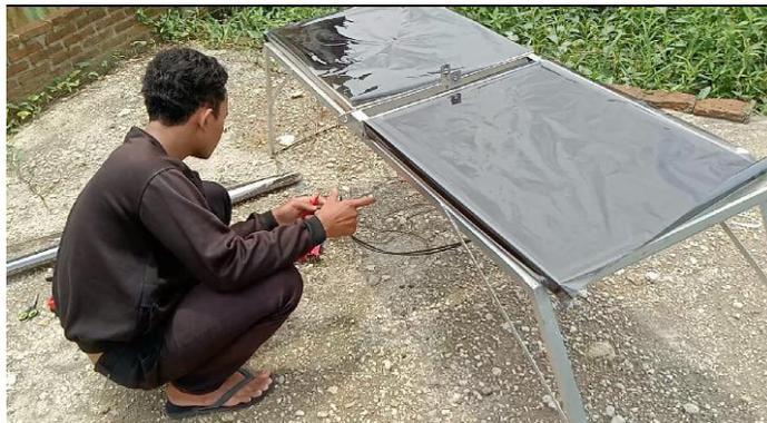
Gambar 4: Pengukuran PLT Monocrystalline dan polycrystalline dengan kaca film VLT 45%
