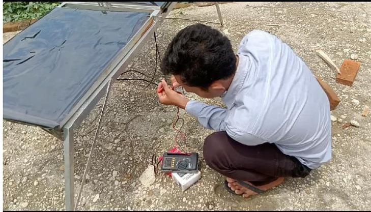
Gambar 3: Pengukuran PLT Monocrystalline dan polycrystalline dengan kaca film VLT 60%
