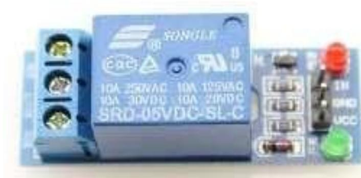
Gambar 2.13 Modul Relay DC 5 volt
