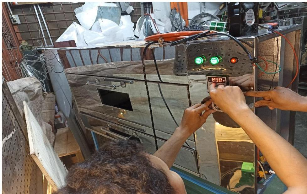
Gambar 4. Pemasangan Thermostat Pada Oven
