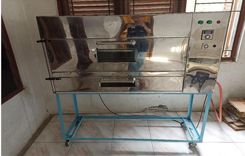
Gambar 5. Hasil Rancangan Dan Kontrol Otomatis Pada Oven
