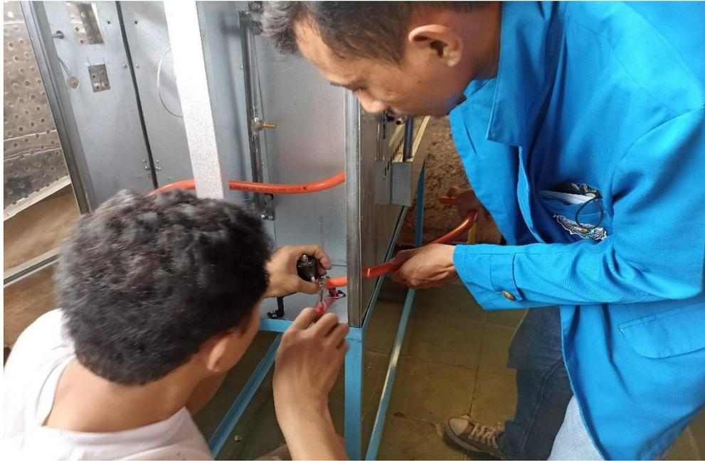
Gambar 3. Pemasangan Selang Aliran Gas Pada Selenoid
