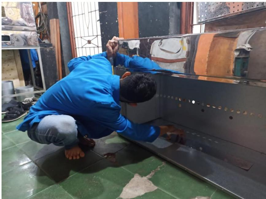
Gambar 4.5. Proses Pemasangan Ruang Dalam Oven
