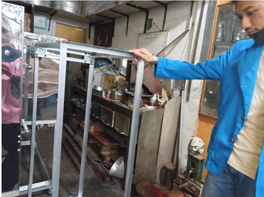
Gambar 4.2. Kerangka Oven Setelah Dirakit
