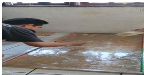
Gambar 4.5 Menuang resin ke dalam cetakan
