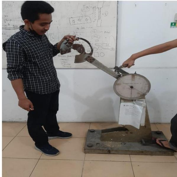
**Foto Pengujian Spesimen dengan uji impak Charpy**
